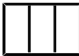
rama z podwójnym poprzecznym wsparciem
